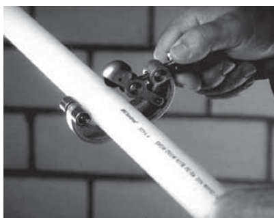
1.Kapa röret till önskad längd med en röravskärare.
