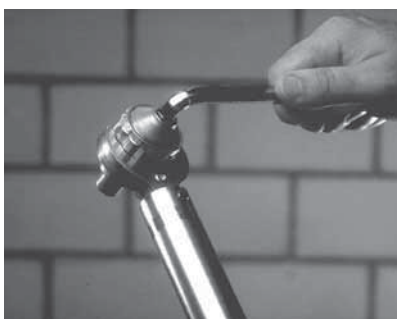
2.Skruva kopplingen på monteringsverktyget med den konade sidan utåt. Dra åt lätt med insexnyckeln.
