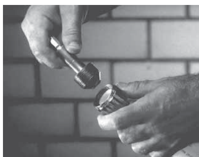
4.Demontera verktyget, vänd det 180 grader och skruva i det igen med den konade sidan inåt.
