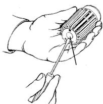
1. Schroef de vandaalkap los van de afsluiter. Verwijder het middelste kapje die over de instelling zit met een kleine schroevendraaier.
