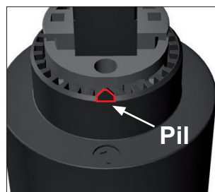
Bild 1. På ovsidan av insatsen sitter pilen som skall peka på önskat läge på varmvattenringen.
