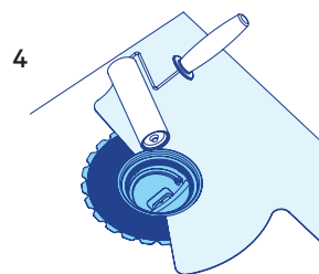
Utbredning av vattenisoleringsflänsen
