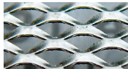
Armering av finmaskig SS 316 syrafast sträckmetall med rombiska celler, passo 3.
