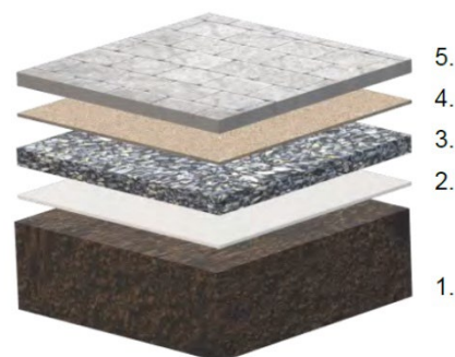
1. undergrund, 2. geotextil N1 3. förstärkningslager 4. justeringslager 5. marksten
