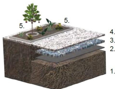
1. undergrund, 2. rotskydd, 3. förstärkningslager, 4. dekorsten, 5. rotbarriär
