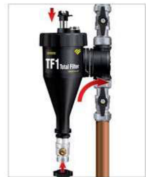
Stäng avtappningsventilen, sätt tillbaka magneten och öppna utloppsventilen
