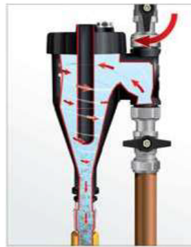
Öppna inlopps- och avtappningsventilerna
