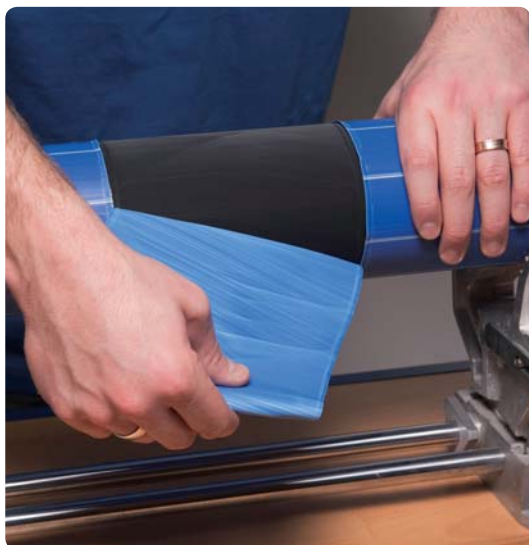
3. Avlägsna det markerade PP-mantelstycket omedelbart före svetsning.
