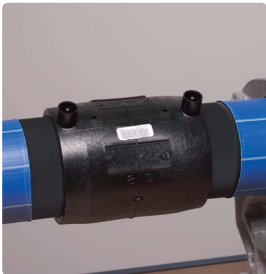
6. Montera svetskablarna, och muffen är klar för svetsning.
