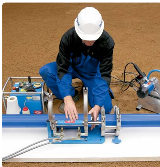
1. Rören spänns upp i stumsvetsmaskinen så att de centreras.
