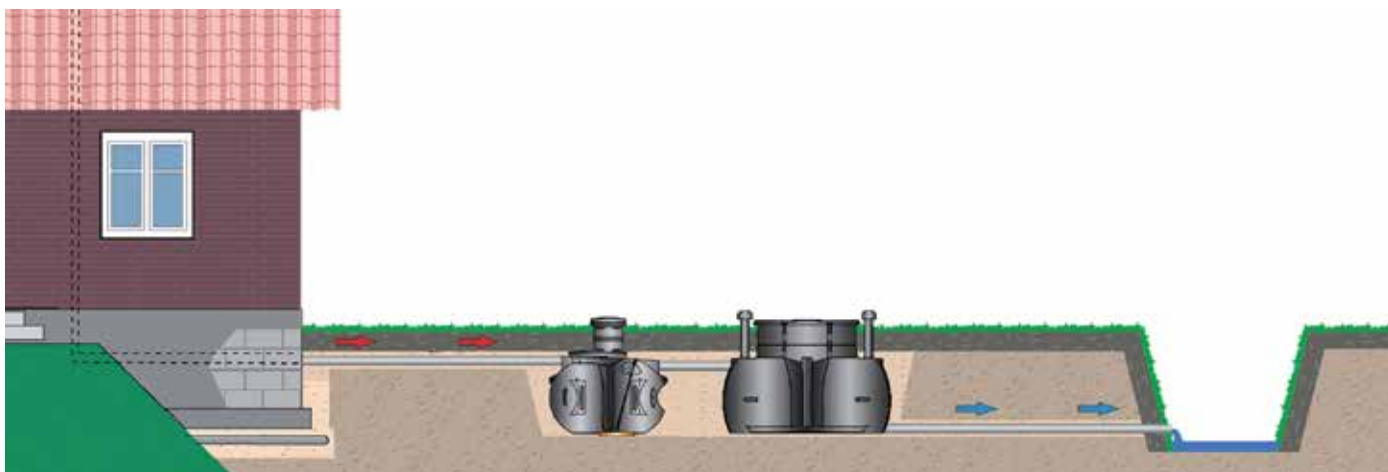
Slamavskiljare 1m 3 och BDT Easy Plus + Förhöjningspaket. För toalett ansluts en sluten tank.
