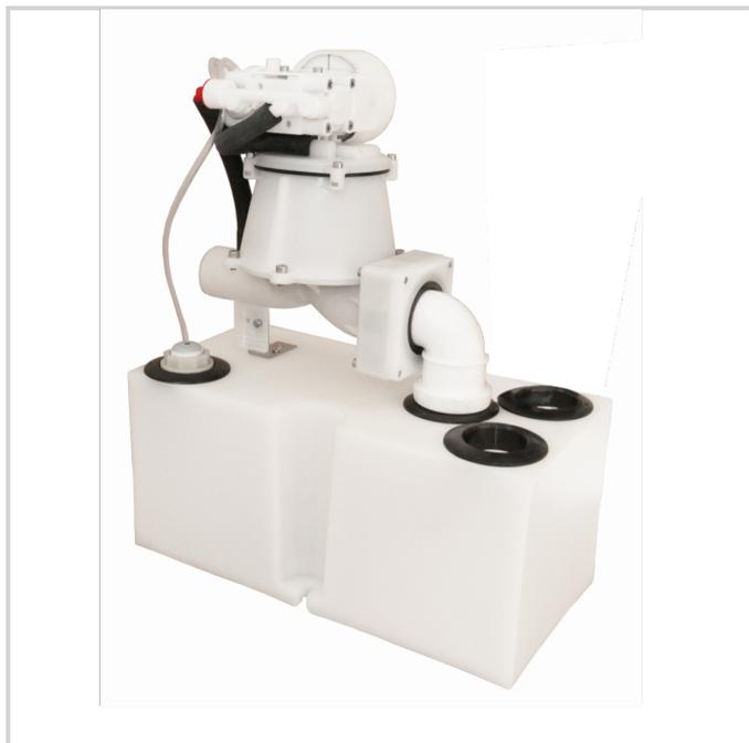
Jets™ [Grey Water Interface Unit] gråvatteneinheit består av en tank med en nivåbrytare och en utloppsventil. Gråvatten leds till tanken med hjälp av gravitationen och rinner in i vakuumsystemet via ventilen. Ventilen aktiveras av vattennivån i tanken.
