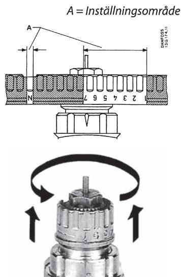
RA-FLX ventilen ger möjlighet till justering av kapaciteten.
