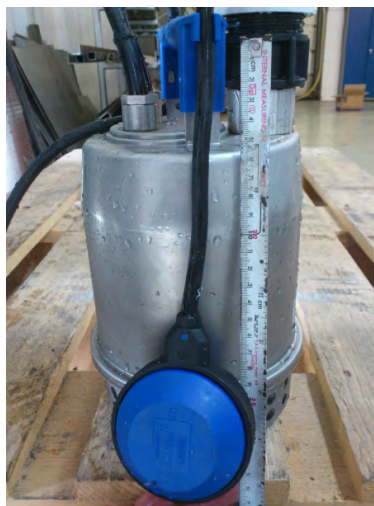
Vippans styrkabel ska vara 150 mm lång från pump till underkant flottör.
