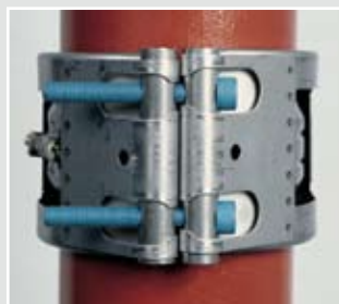
4. Dra åt kragens bultar tills svepen möter varandra. Kragens tänder griper nu runt bägge rörändarna och säkrar sammanföringen mot tryck upp till 10 bar.
