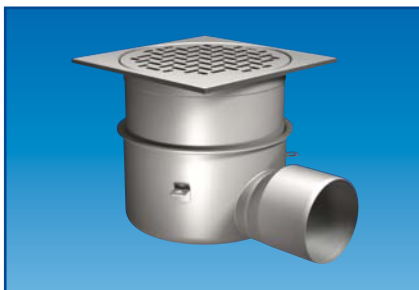
Påbyggnadsdel*. Om 2,7 L silkorg eller 1,5 L sandfång väljs som tillbehör till golvbrunnen, krävs en påbyggnadsdel. Totalhöjden blir då samma som för brunn med ett inlopp.
