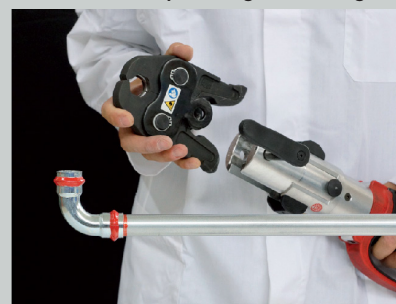
Figur 26 Ihopmontering av pressverktyg
