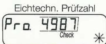
Abbildung 2: Displayanzeige der Eichtechnischen Prüfzahl
